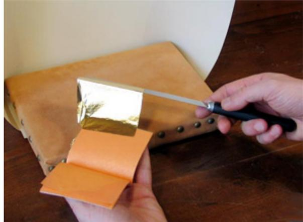
Arriba pan de oro, abajo una imagen con el pan de oro colocado. Este metal se bruñe con piedra ágata.
